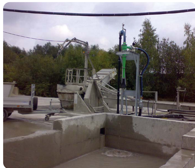
Zyklon mit Schrägbecken Cyclone with slant basin
