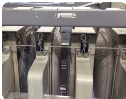
Nachpressen mit Druckluft Repressing with compressed air
