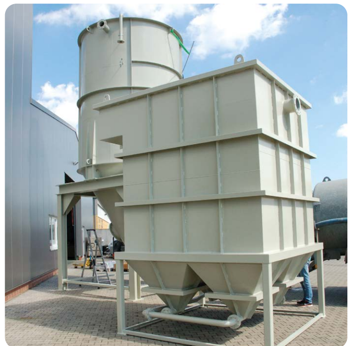
Lamellenklärer für Durchsatz 20 m 3 /h Lamella clarifier for flowrate 20 m 3 h
