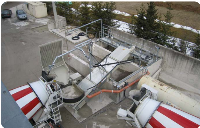
Auswaschschnecke mit hydraulischer Hebevorrichtung washout screw with hydraulic elevator
