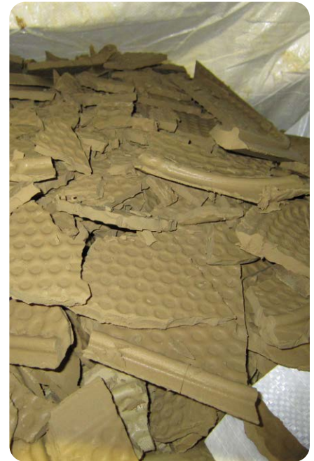
Filterkuchen im Container Filter cake in the container
