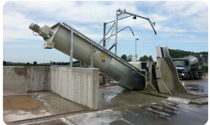
Ausführung mit Heizung und Isolierung Version with heating and isolation
