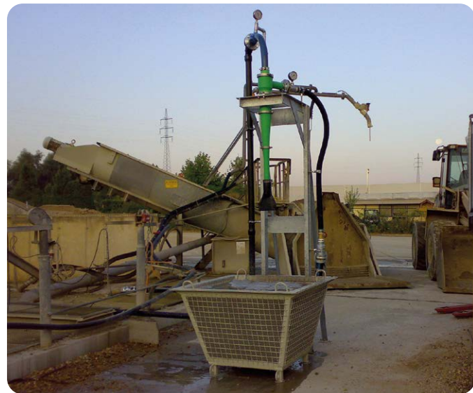
Zyklon mit Entwässerungskorb Cyclone with dewatering box
