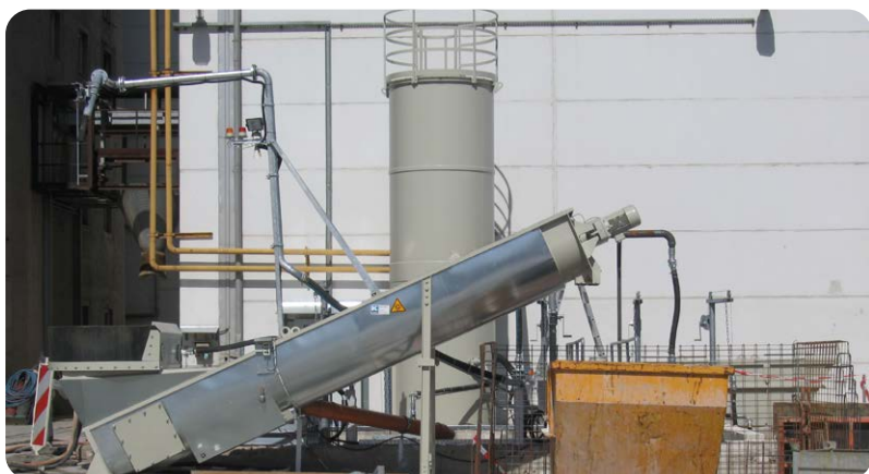
Auswaschschnecke mit Klärturm Underground screw with sedimentation tower
