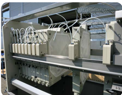
Filterplatten mit Rüttelvorrichtung Filter plates with vibration device
